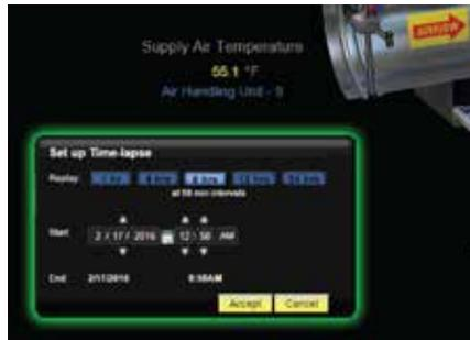
Überprüfung von Grundrissen, Anlagen-Grafiken, Trends und Alarmen über einen vergangenen Zeitraum, so dass Sie Gebäuderegelungs-Probleme schnell identifizieren und lösen können.
