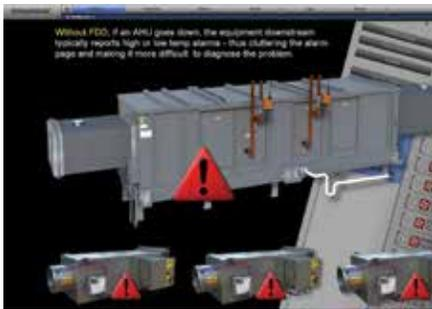
Automatische Unterdrückung nachgeschalteter Anlagenalarmler mit WebCTRL-Fehlererkennung und -diagnose (FDD) zur Erleichterung der Diagnose von Problemen.
